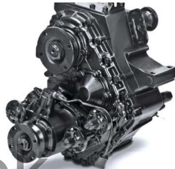
При движении по скользким дорогам, для предотвращения буксования колес, в раздаточной коробке предусмотрена блокировка дифференциала приводов переднего и задних ведущих мостов.
